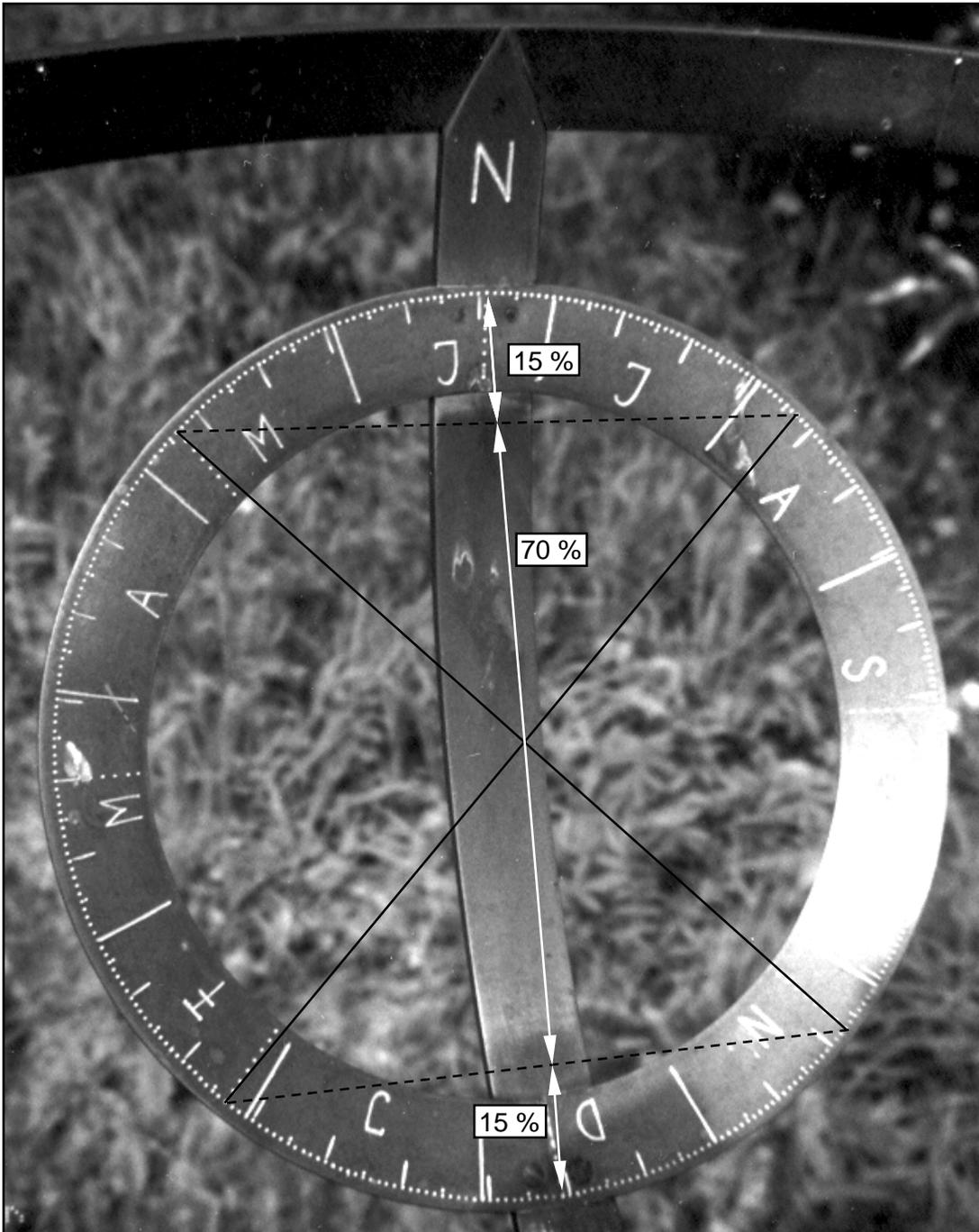
**Abbildung 6:** Der Jahresring mit der Unterteilung in die Speichertage und mit den Änderungen des Jahreswinkels in den einzelnen Quartalen
